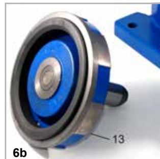
6b) Remplacer le plateau 13 avec graphite usée par un neuf.
