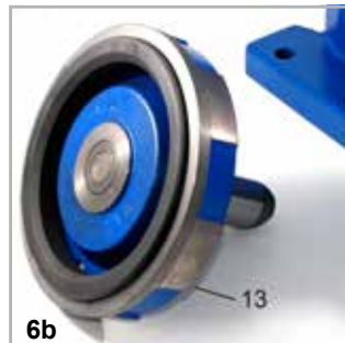
6b) Sostituire il platorello 13 con grafite usurata con uno nuovo.
