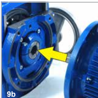
9b) Remonter le moteur en revissant les 4 vis de fixation de la bride et effectuer environ 20 rotations de l'arbre du moteur dans les deux sens.
