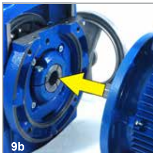
9b) Riassemblare il motore riavvitando le 4 viti di fissaggio della flangia ed effettuare circa 20 rotazioni dell'albero del motore in entrambi i sensi
