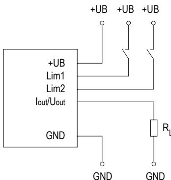
Abb. 4: Anschluss Strom- und Spannungsoutput
